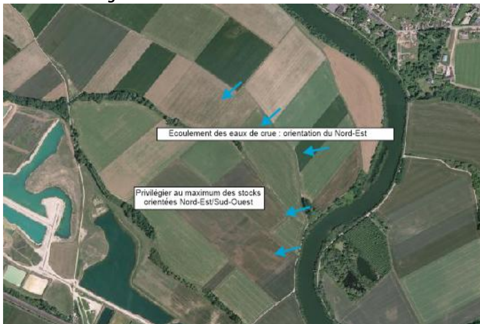
Schématisation du sens d'écoulement des eaux de crue
